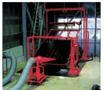
散水送風試験
