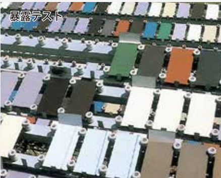
塗装鋼板のテストピースを沿岸部など過酷な自然環境のもとで、20年、30年と年月をかけて耐候性を調べています。
